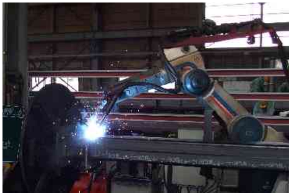
最新型ロボットによる構造材溶接
